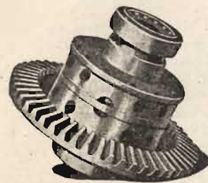
Curioso tipo di differenziale americano: a destra smontato in tre parti, a sinistra montato nella sua scatola munita di corona dentata.
